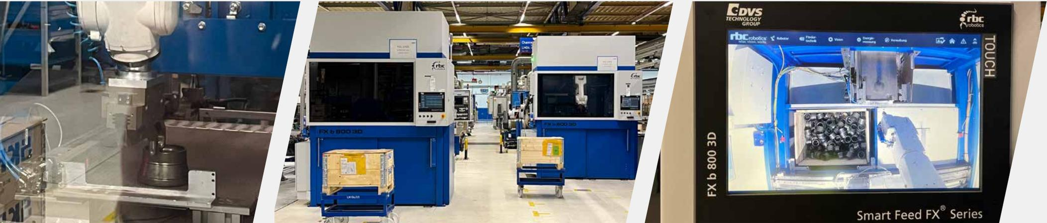
das eine manuelle Programmierung des Roboters erforderlich ist. Die Ringabmessungen werden eingegeben und das Setzmuster wird automatisch berechnet und an den Roboter übermittelt.
