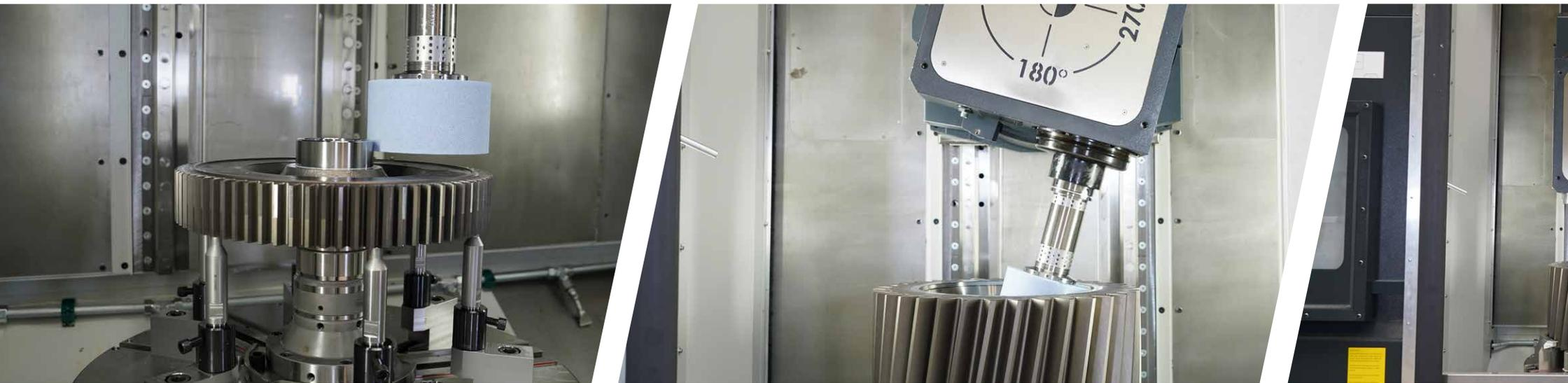
geometrischer Toleranzen. Durch die Fertigung von Bauteilen in einer einzigen Spannung werden kumulative Fehler beim Umspannen eliminiert, was zu überragender Bauteilqualität und Geometrie führt.
