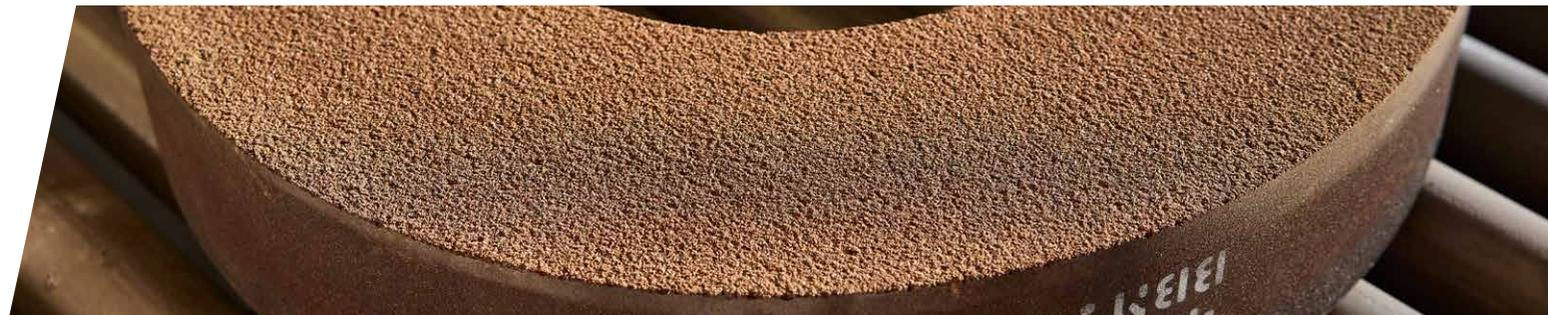
Das in der Schleifscheibe verwendete und neu entwickelte, innovative Harz sorgt für eine geringe, einstellbare Bindungsmenge. Die Schleifscheibe ist dadurch kornreich, weichschleifend und hervorragend abrichtbar. Ein weiteres Plus ist die verbesserte Nassschliffestigkeit, die ebenfalls auf das neu entwickelte Harz zurückzuführen ist.
