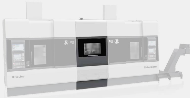
Zwei SkiveLine-Maschinen können von einer PAC-Zelle beladen werden.
