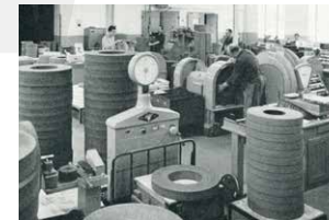
Fertigung der ersten, keramisch gebundenen Schleifscheibe für die Kurbelwellenbearbeitung
