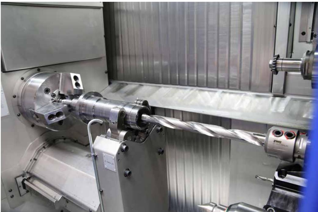
Tieflochbohren nach dem Vorbohren
