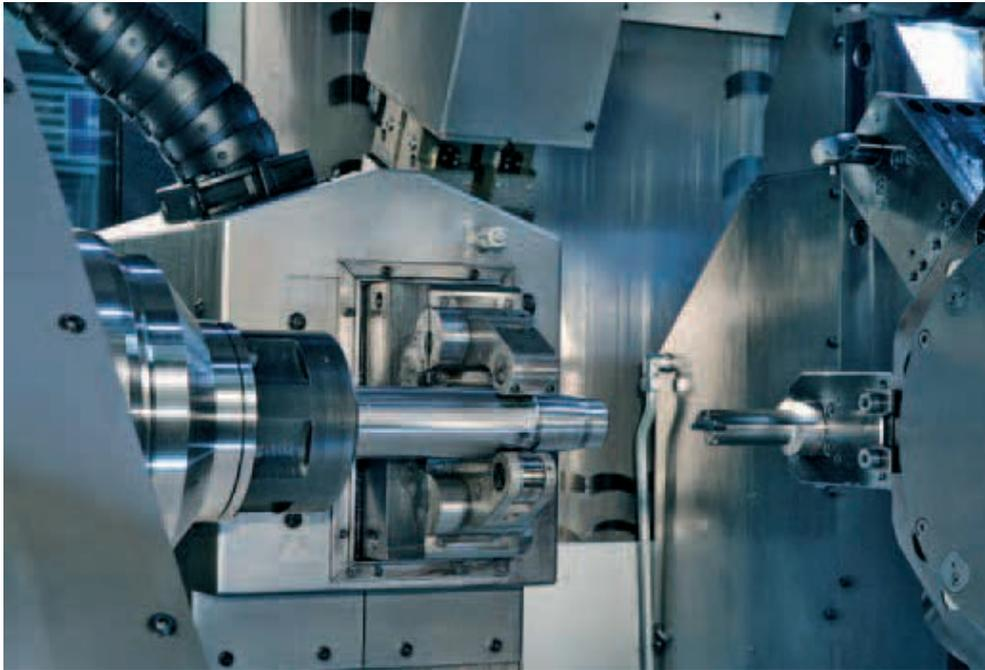
Pilotbohren für die Tieflochbohrung
