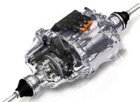
Abb1: Beispiel einer E-Achse in elektrischen Fahrzeugen. Die Anforderungen an Getriebekomponenten im Antriebsstrang weisen eine Verzahnungsqualität 4 bis 5 (DIN 3961) und eine sehr geringe Oberflächenwelligkeit aus. Sie verfügen über eine geringe Rauigkeit (Neigung zu feinsten Oberflächen) und enge Form- und Lagetoleranzen zur Vermeidung von Unwucht.
